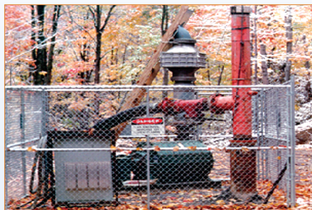
Рисунок 2: Выработанная скважина, используемая для откачки шахтного метана из пластов угля, обрушившихся после разработки.
